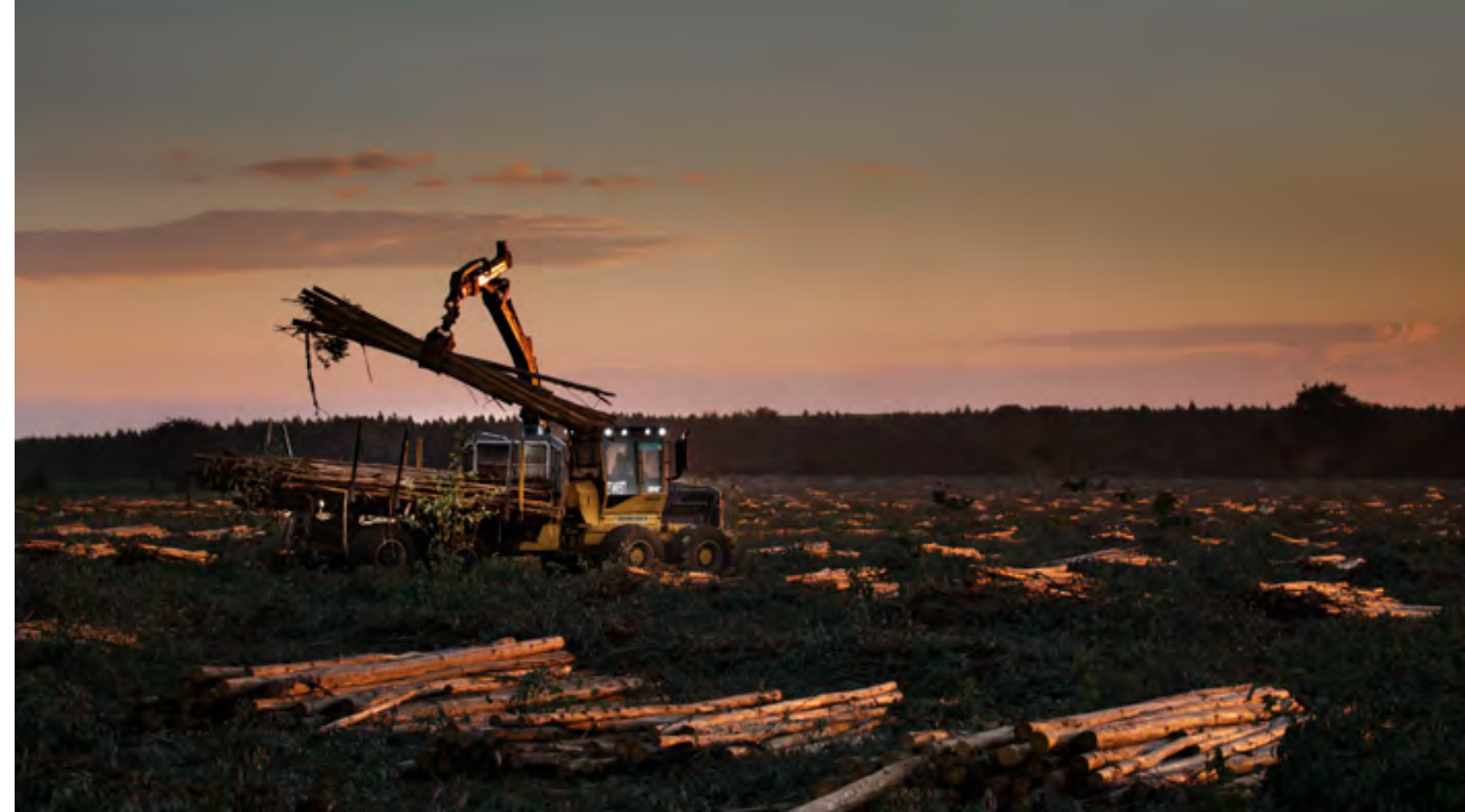
Máquina forwarder empilhando as toras de eucalipto após a colheita, no Mato Grosso do Sul. Foto Araquém Alcântara
